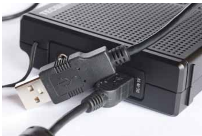
Seine externe 5-Volt-Stromversorgung bezieht der Empfänger aus einem USB-Anschluss oder einem externen Ladegerät.
