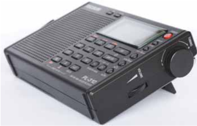
Auf der rechten Gehäusesseite des kompakten Weltempfängers liegen der VFO-Knopf und der Lautstärksteller; beide haben eine Rasterung.
