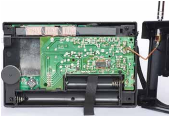
Ein Blick ins Innenleben des PL-310: Oben ist die Ferristabantenne für Lang- und Mittelwelle zu sehen.
