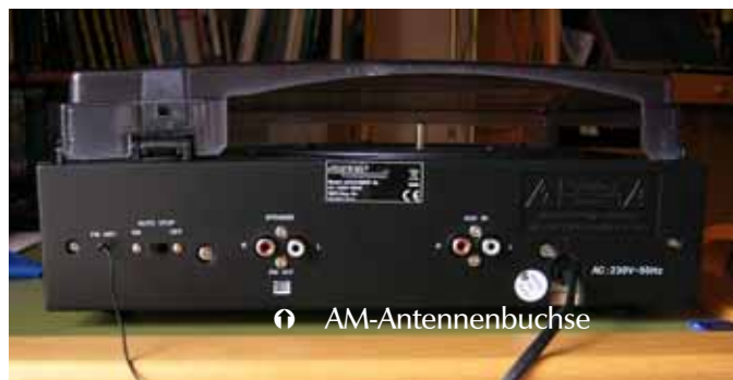
Links die UKW-Antenne, daneben der Ausschalter für den automatischen Platten-Stop und die Cinch-Buchsen.
