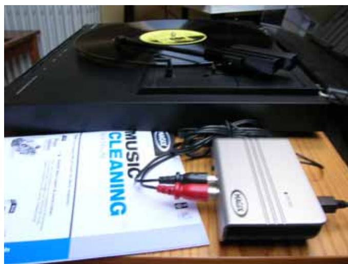
Der Phonovorverstärker während einer Aufnahme: links die beiden Cinchkabel vom Plattenspieler, rechts das Massekabel und die USB-Verbindung zum Notebook.
