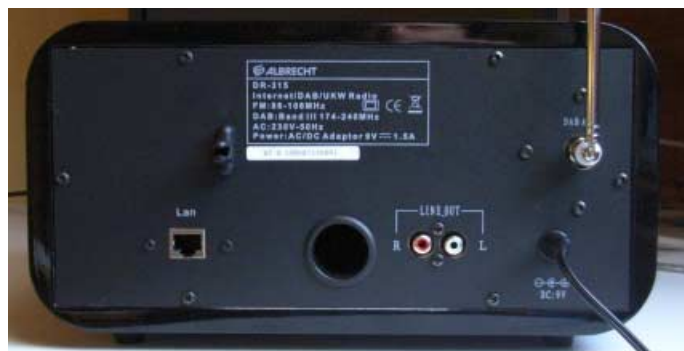
Der LAN/WLAN-Anschluss und der Ausgang des Bassrohres sowie die Cinch-Buchsen sind gut zu erkennen. Foto: urc
