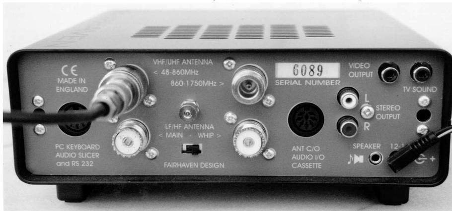
Anschlussfreudig: Der Fairhaven bietet jede Menge Verbindungsmöglichkeiten, auch ein Anschluss für einen Kassettenrekorder und ein Stereoausgang sind vorhanden.
