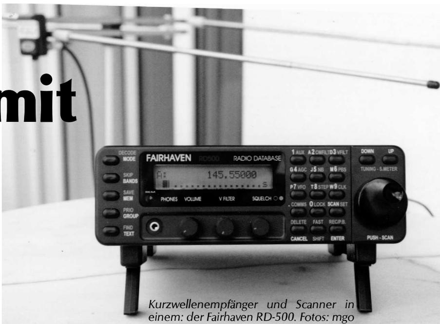
Kurzwellenempfänger und Scanner in einem: der Fairhaven RD-500. Fotos: mgo
