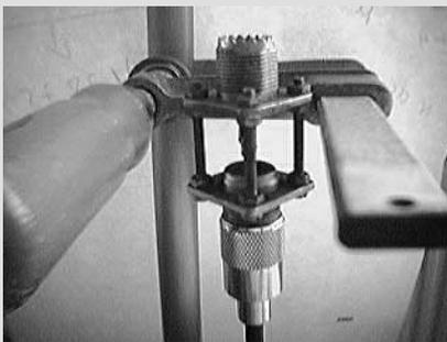
der PL-Flanschbuchse bleibt frei. Diese wird an der Schraubzwinde, wo ein 3 mm großes Loch gebohrt werden muss, mit der Flügelschraube befestigt.
