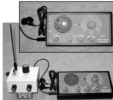
Sehr starke Sender wie z.B. BBC, die teilweise mit Signalen von S9+40 dB hereinkommen, können schonmal über einige 100 kHz verfolgt werden. Hier nützt auch der eingebaute Abschwächer nur noch bedingt...
