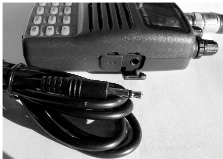
Ein handelsübliches Kabel mit 3,5-mm-Klinke steckt für den Anschluss des Scanners an die Soundkarte aus. Fotos: urc
