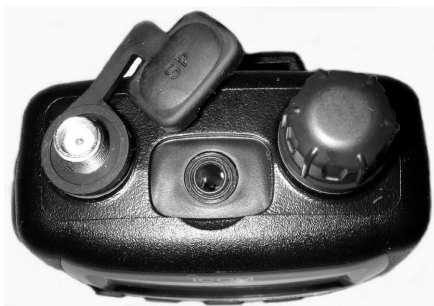
Oberseite mit SMA-Antennenbuchse.
