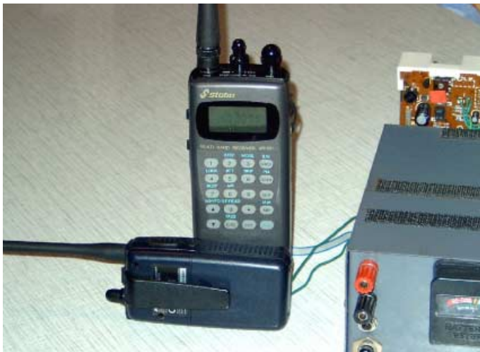
Scanner mit Alan-LPD: ein einfacher „Umsetzer“ – Scanner empfängt und LPD sendet. Fotos: Bernd Trampel
