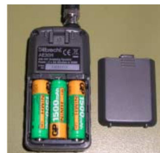
Unspektakuläre Rückseite des AE 30H. Positiv: preiswerte Mignon-Akkus verwendbar.
